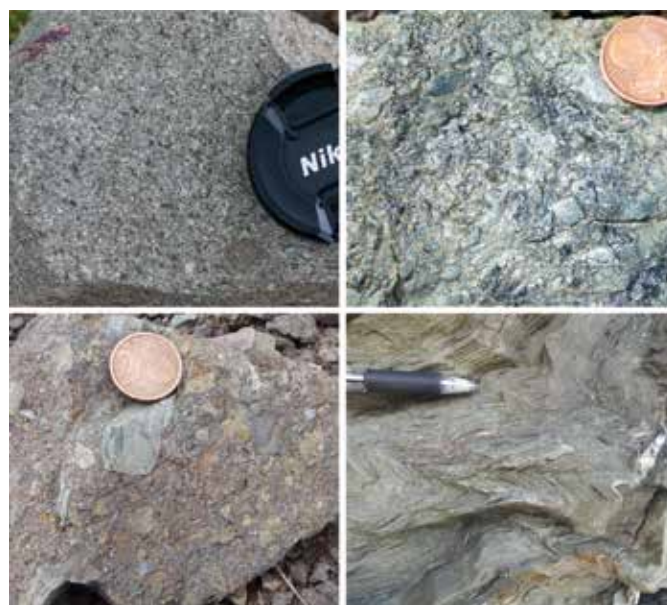
Figura 3 – Esempi delle principali rocce che si possono trovare lungo il percorso. Da sinistra in alto: andesite, breccia di fluidificazione, breccia piroclastica, fillade - ph Erik Unterpertinger
